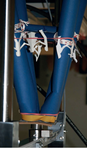
Siegerturm vor dem Abdrücken und Stabilitätsverlust durch das Knicken einer Turmsäule
