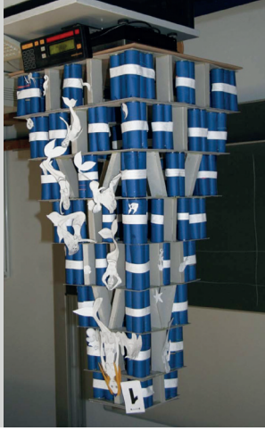
Kreativster Turm vor dem Abdrücken und Stabilitätsverlust durch Knicken
