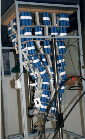
Kreativster Turm vor dem Abdrücken und Stabilitätsverlust durch Knicken
